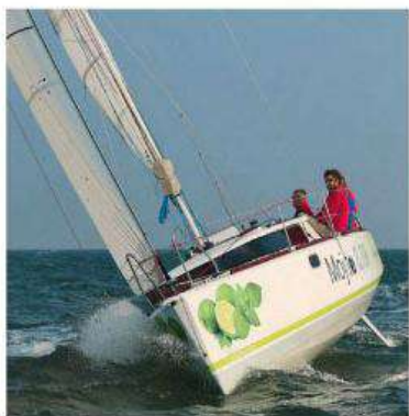
▲ Il fallait oser le rouf panoramique à vitrage verticaux, mais ça passe !
